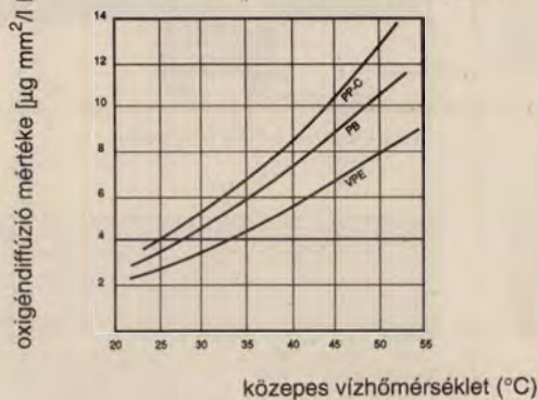
1. ábra oxigéndiffúzió középértéke PPC, PB és VPE fűtőcsövek esetén
